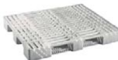
COD. ART. F PU 3040 00 01 Pallet Plástico Medida: 1200 x 1000 x 150 h.mm. Capacidad de carga estática: 4000 Kg. Capacidad de carga dinámica: 1250 Kg. Color: Negro.
